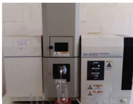
Атомын шингээлтийн спектрофотометр - shimadzu-6300c
