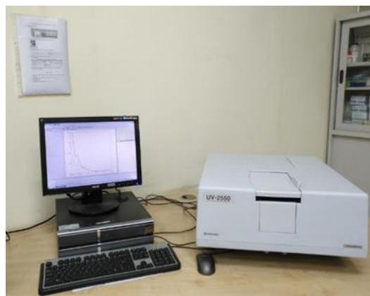
Хэт ягаан туяаны спектрофотометр/ /UV-2550/
