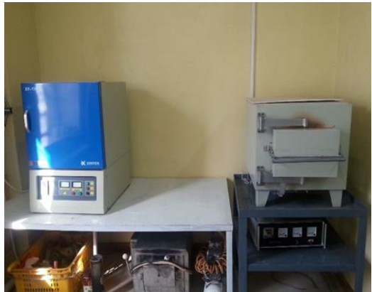
Шил хайлуулах (XY-1700), шатаах (SX10-12) лабораторийн зуухнууд
